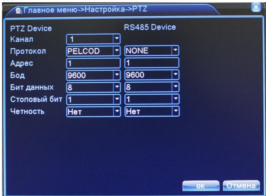
**КАНАЛ:** Выбор канала, на котором подключена поворотная камера
