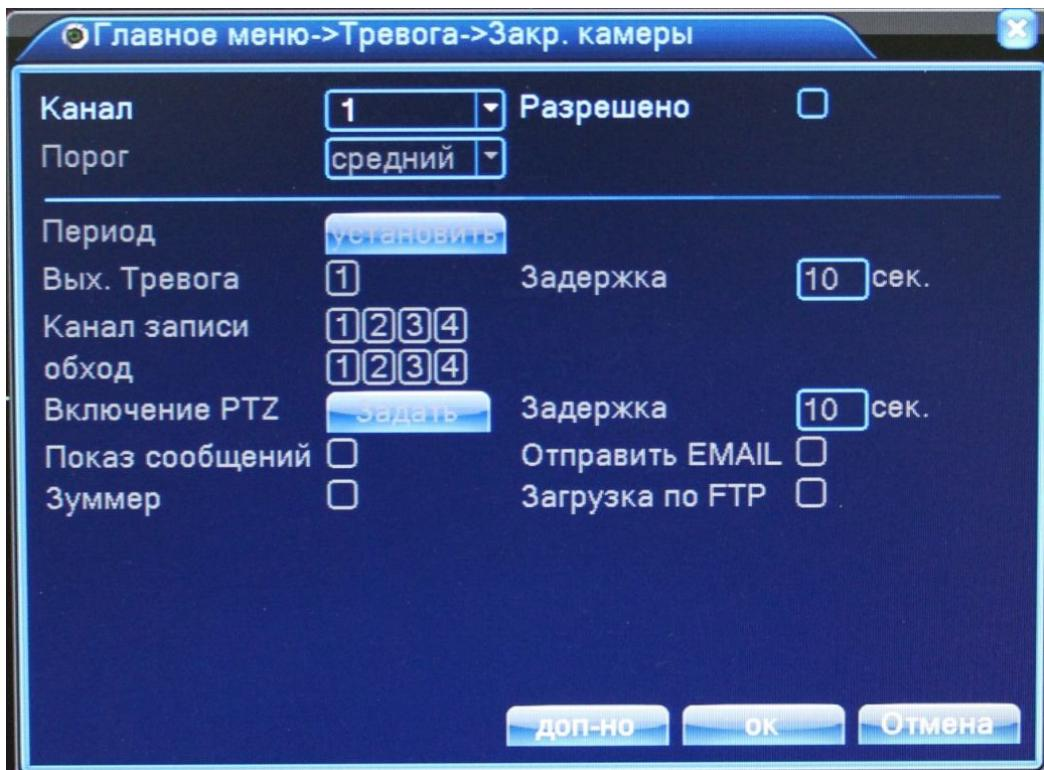
**КАНАЛ:** выбор канала, на котором будет фиксироваться закрытие камеры
