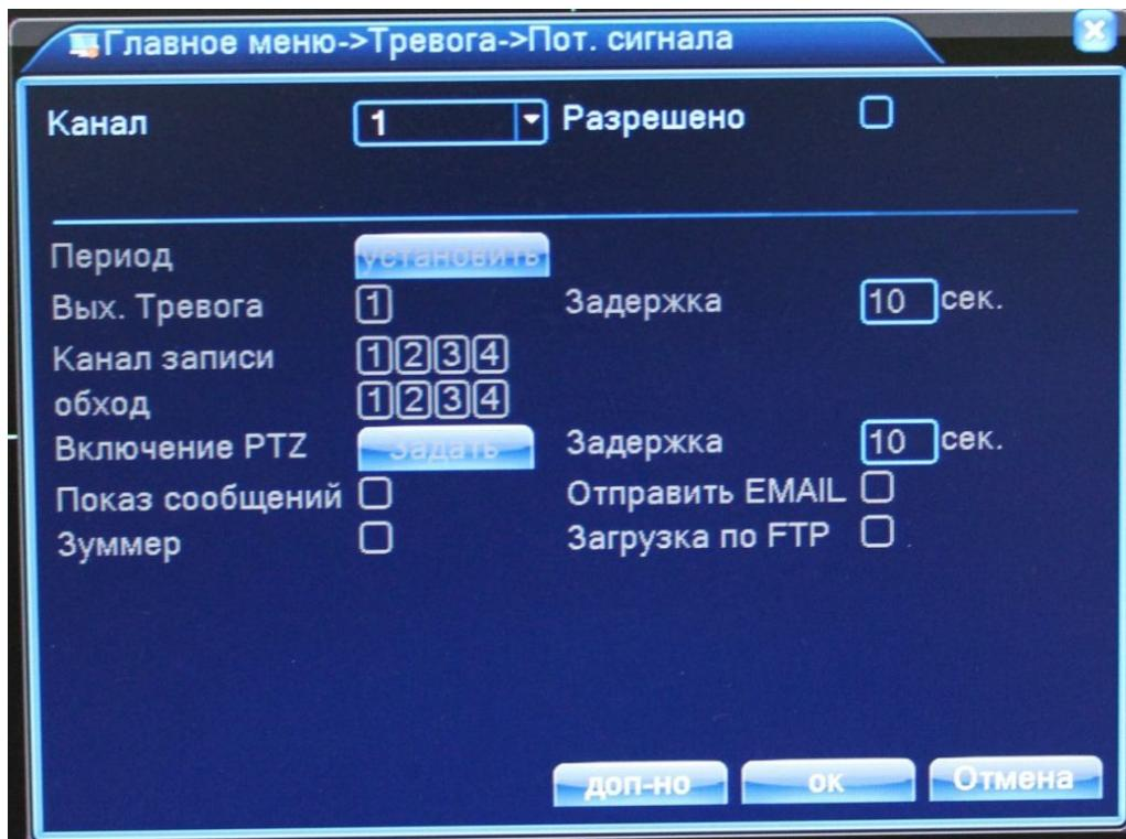
**КАНАЛ:** выбор канала, на котором будет фиксироваться потеря сигнала
