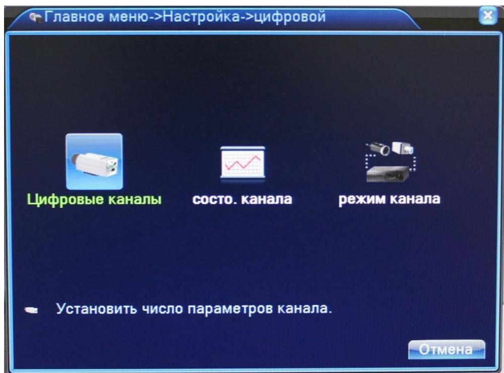
ЦИФРОВЫЕ КАНАЛЫ: Настройка подключения IP-камер
