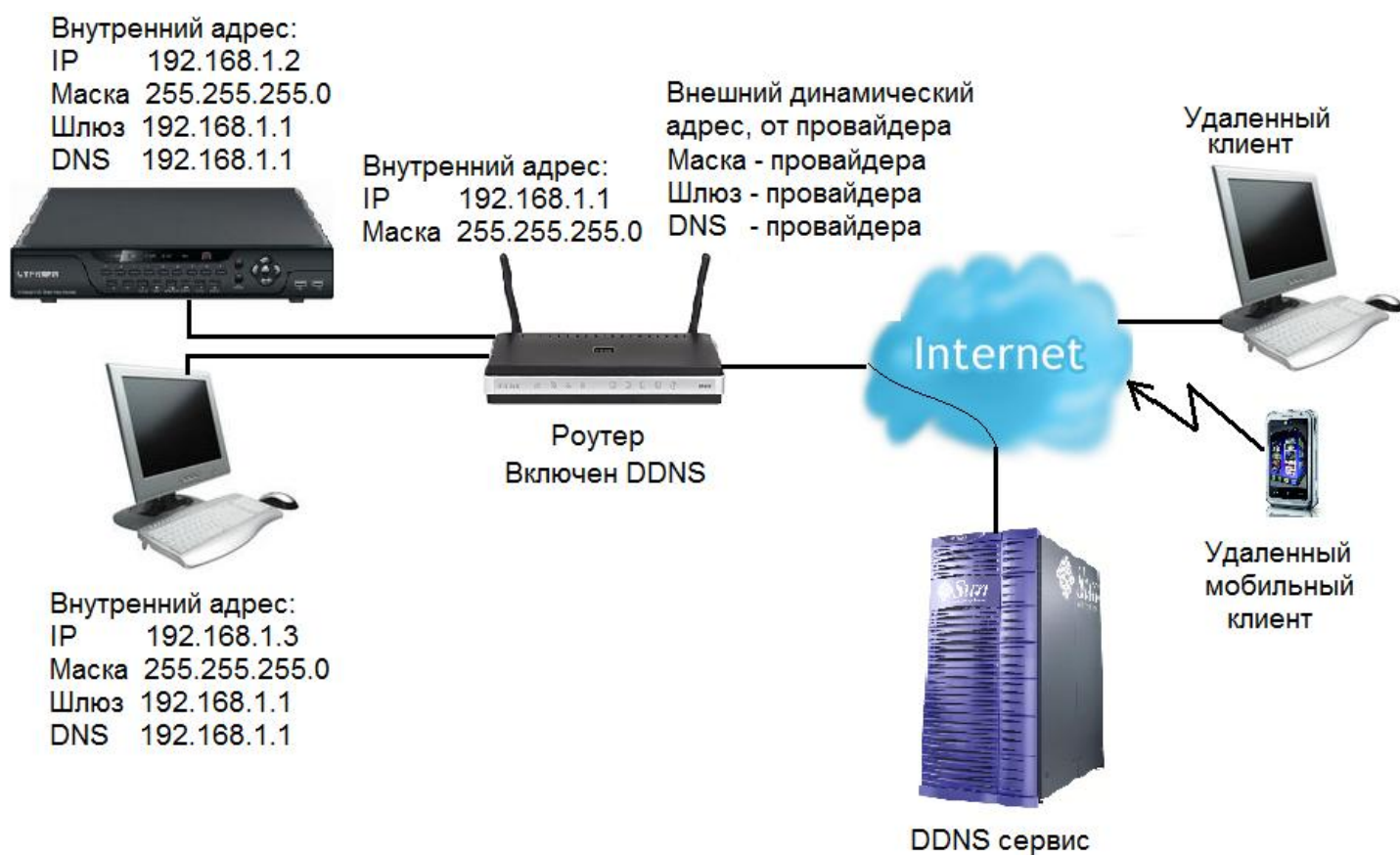
Рисунок 6-1 Типичная схема подключения видеорегистратора к интернету
