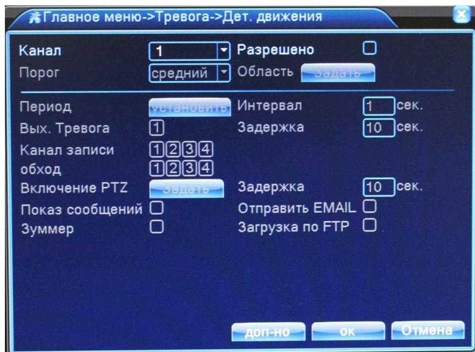
**КАНАЛ:** выбор канала, на котором будет фиксироваться движение
