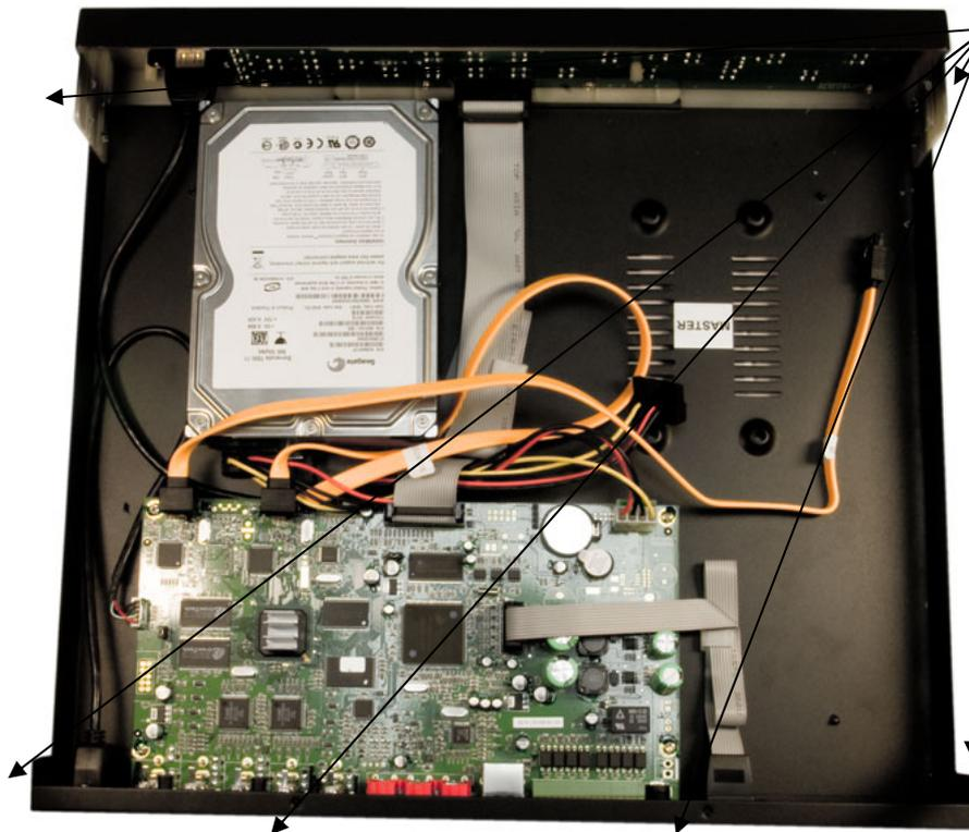
Снять верхнюю крышку устройства: для этого откручиваются по 3 винта на боковых сторонах корпуса и 2 винта на верхней стороне: которые держат верхнюю крышку.
